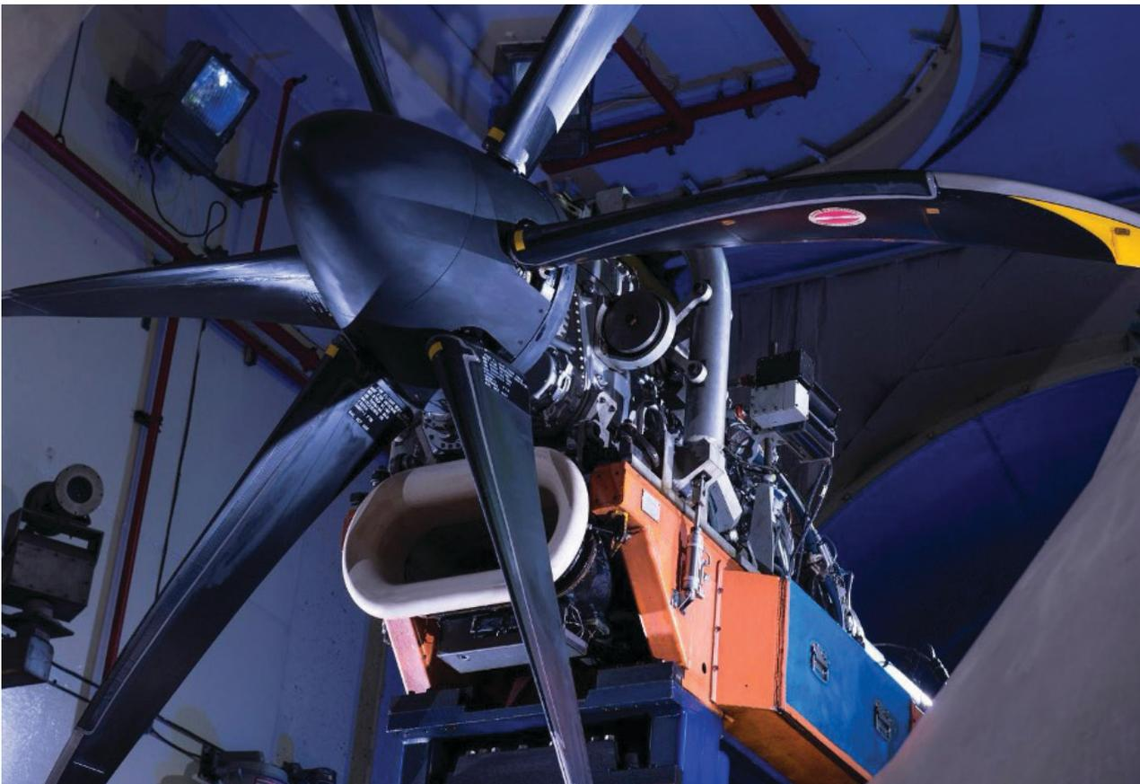
Une opération 100 % CAD sera étudié sur un turbopropulseur PW127, montré ci-dessus dans une cellule de test.
