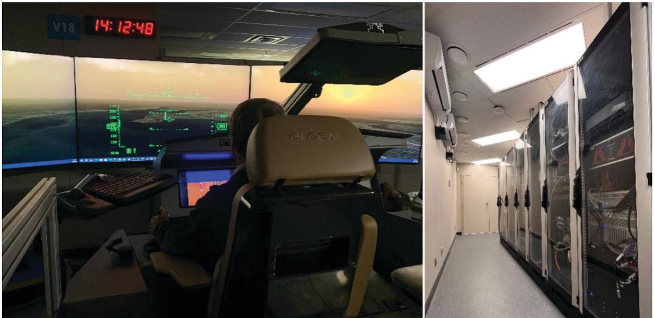
*Banc d'essai LISCA : un simulateur de vol qui a été mis au point pour mettre à l'essai de nouvelles avioniques, de nouveaux systèmes de contrôle d'aéronefs et de nouveaux logiciels avancés*
