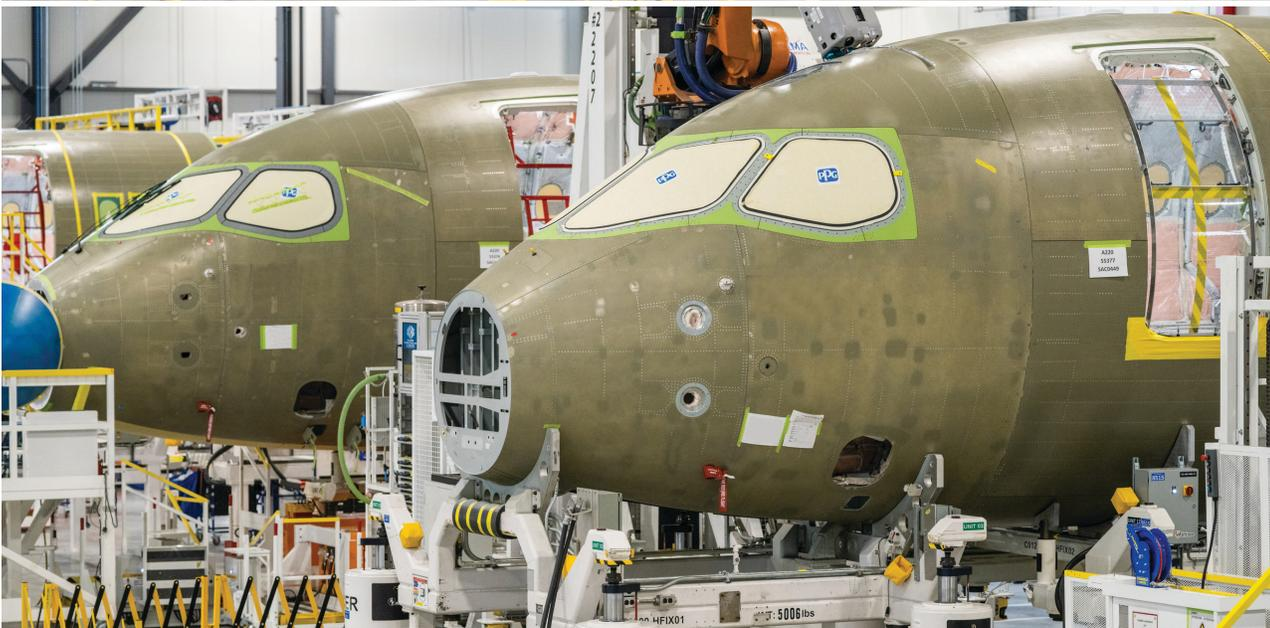
*Jonction de la pointe au tronçon avant de l'A220 au moyen de robots, Airbus Atlantique Canada*
