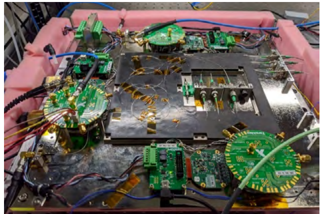
Figure 3 : Unités de qualification de la source laser multifréquence haute fiabilité en préparation pour être installées dans l'enceinte de cyclage en température.
