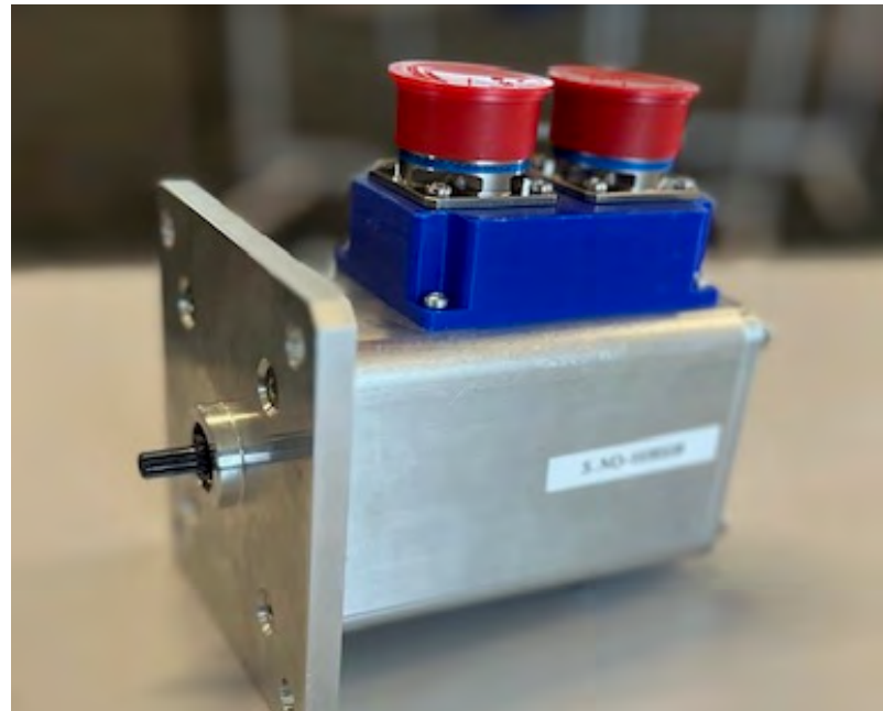
Deuxième prototype du moteur électrique de l'actionneur électromécanique.
