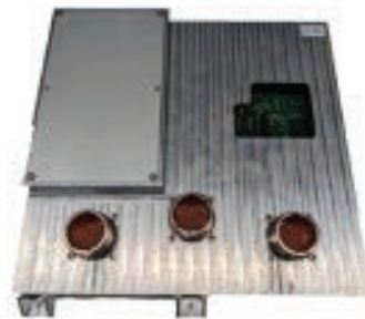
Calculateur critique de commandes de vol ultra-compact
